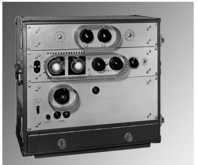
Ein Verstärkersatz zum Magnetophon K 5. Oben der Wiedergabeverstärker, in der Mitte der Lautsprecher-Verstärker, unten das Netzgerät. Das Bild des zugehörigen Lautsprechers ist nicht mehr auffindbar.
