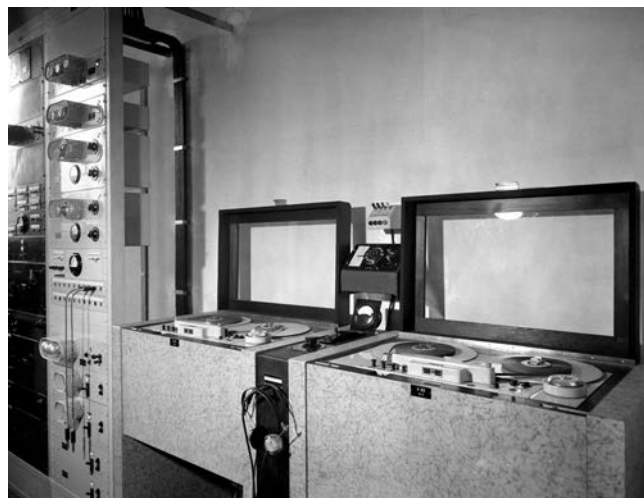
Magnetofonanlage R 122 (so die RRG-Bezeichnung). Verstärker und Netzgeräte für die beiden Laufwerke R 22 sind in dem Verstärkergestell links im Bild eingebaut.
