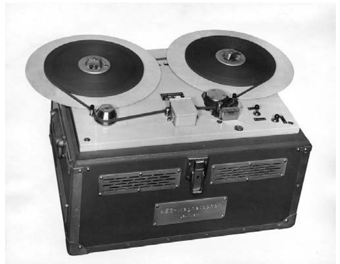
Das Nur-Wiedergabegerät Magnetophon K 5, Laufwerk. Die Mechanik entspricht weitgehend der des Magnetophons K 4. Das kleine Abschirmgehäuse (vorn Mitte) verdeckt den Wiedergabe-Magnetkopf. Die Begleitpapiere bezeichnen dieses Exemplar als „Führergerät“.
